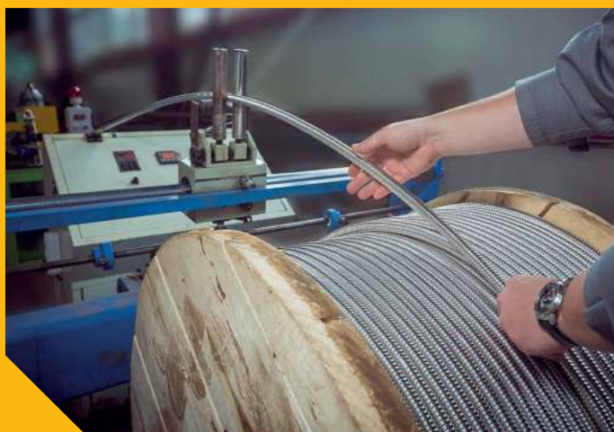
Подача гофрированной трубы Stahlmann для отжига
