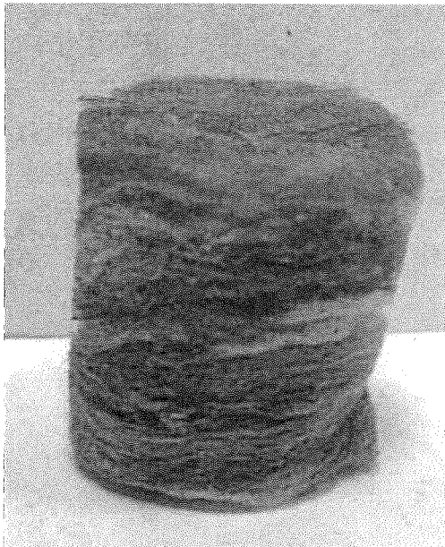
Фото 1-2. Образец изделия (плиты) теплоизоляционной «ТИСМА» из минеральной ваты, полученной из расплава стекла на полимерорганическом связующем, марка TS 038 Aquastatik, до и после испытания.
